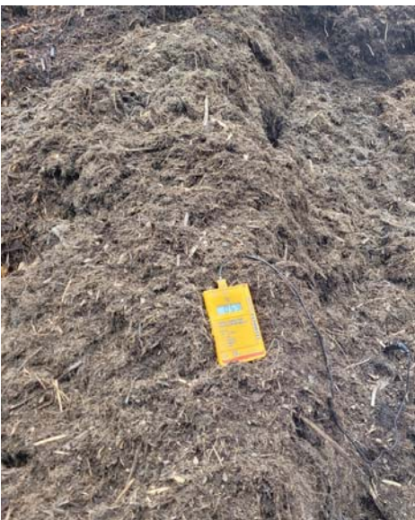
Auf bis zu 70 ° C kann sich eine Kompostmiete erhitzen. In diesem Fall waren es knapp 60 ° C.
